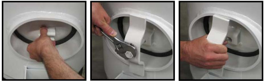
Collegare il **Tubo di sabbatura** e fissarlo con i perni di sicurezza.
