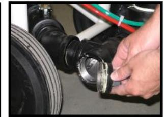
5. Se l'ostruzione dipendeva dallo **Sponge Media**, portare il regolatore della **Pressione alimentazione del materiale** a 0 bar (0 psi). Verificare che la **Valvola dell'aria** sia completamente aperta; o parallela alla tubazione. Riprendere la sabbatura. Quando si ottiene un flusso d'aria senza **Sponge Media**, riportare lentamente il misuratore **Pressione di alimentazione materiale** alla pressione desiderata.
