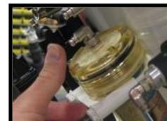
Se non si sente un flusso d'aria dalla parte superiore del **Filtro essiccatore**, sostituire il **Filtro essiccatore** accoppiando le linee dell'aria prima di rimuoverlo. È necessario scambiare i collegamenti delle linee dell'aria dal vecchio filtro al nuovo. Verificare nuovamente che ci sia un flusso d'aria continuo nella parte superiore del **Filtro essiccatore**.
