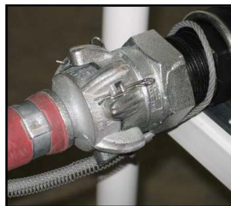
Per un tubo di alimentazione fino a 50 m (150 piedi), utilizzare il Diametro Interno Minimo della Linea dell'aria come elencato sotto. Per una lunghezza da 50 a 90 m (da 150 a 300 piedi), utilizzare almeno una misura del diametro in più rispetto a quanto elencato sotto. I tubi più grandi diminuiscono la perdita di pressione.
