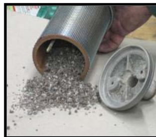
Togliere il materiale accumulato nel **Contenitore materiale di scarto** e reinstallarlo. **AVVERTENZA:** Non mettere in funzione l'apparecchiatura senza **Contenitore materiale di scarto**.
