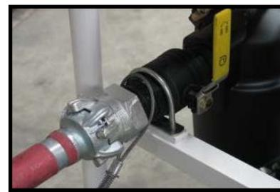
Dopo che il compressore si è spento completamente, aprire la **Valvola a sfera principale**.
