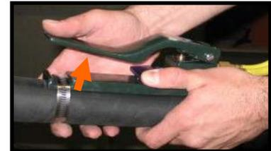
Chiudere la **Valvola a sfera principale**, spegnere il compressore e chiudere la valvola a sfera della linea di alimentazione del compressore.
