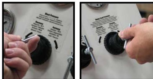
2. Girare la manopola regolatore **Pressione di alimentazione materiale** su "off" ruotandola fino a che si toglie dal **Pannello di controllo**.
