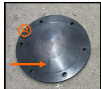
**Il Motore pneumatico si blocca all'avviamento; diventa lento a Pressioni inferiori del materiale**
